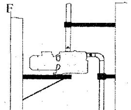
Рекомендуется устанавливать насос как можно ближе к перекачиваемой жидкости. Внутренний диаметр трубопроводов не должен быть меньше диаметра выходного отверстия. При высоте всасывания более четырех метров или значительной протяженности горизонтального
